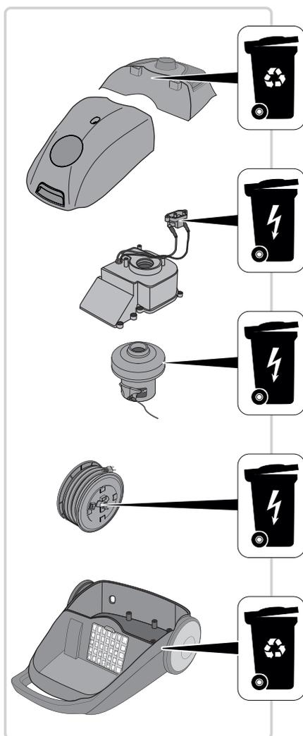
Lösen Sie dafür alle Verschraubungen und Verbindungen, bis die Gerätekomponenten wie folgt separat voneinander entsorgt werden können:
